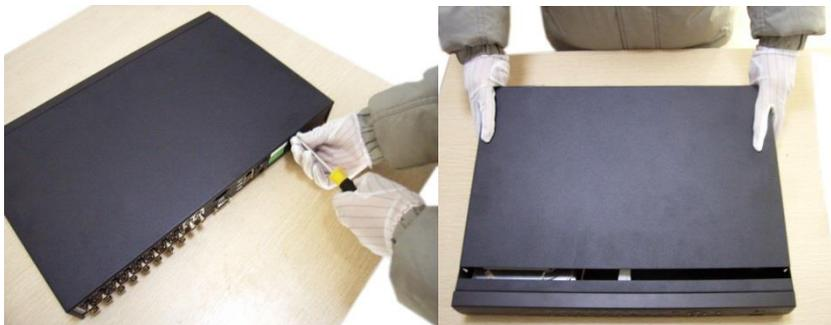
Открутите шурупы и снимите верхнюю крышку устройства
